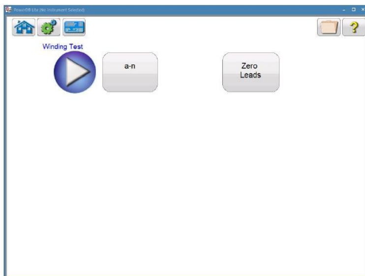
Rysunek 46: Ekran pomiaru rezystancji uzwojeń przekładnika napięciowego
