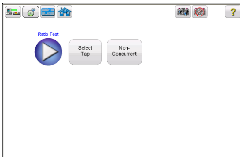
Rysunek 70: Ekran konfiguracji pomiaru przekładni – osobny pomiar dla poszczególnych par zacispów (Individual Measurement, Non-Concurrent)
