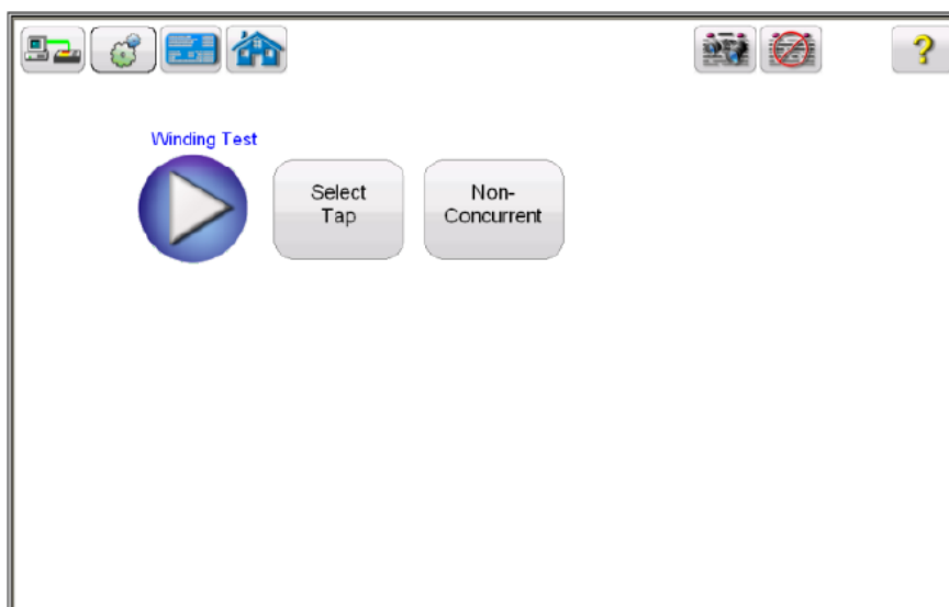
Rysunek 78: Ekran konfiguracji pomiaru rezystancji uzwojeń – osobny pomiar dla poszczególnych par zacsepów (Individual Measurement, Non-Concurrent)
