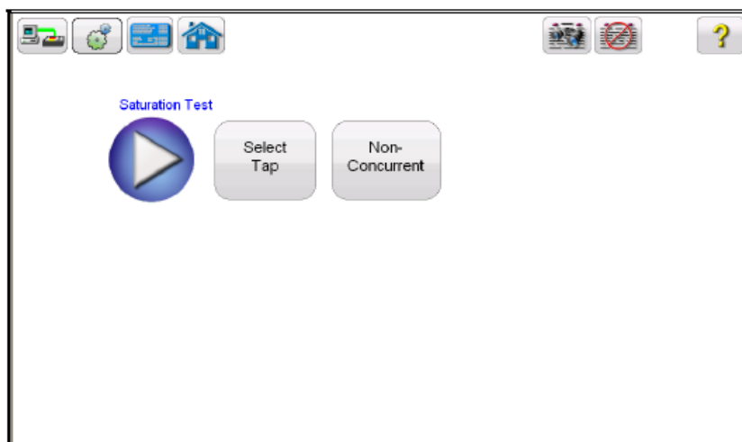
Rysunek 63: Ekran konfiguracji pomiaru charakterystyki magnesowania („test nasycenia”) dla pojedynczej sekcji uzwojenia (Individual Measurement, Non-Concurrent).
