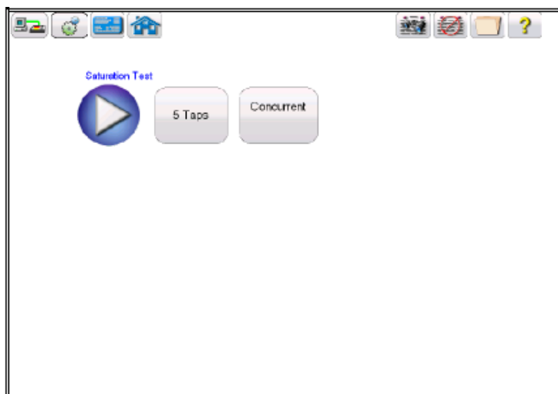
Rysunek 59: Ekran konfiguracji pomiaru charakterystyki magnesowania („test nasycenia”) jednocześnie dla wszystkich par zaczepek (Simultaneous Measurement, Concurrent).
